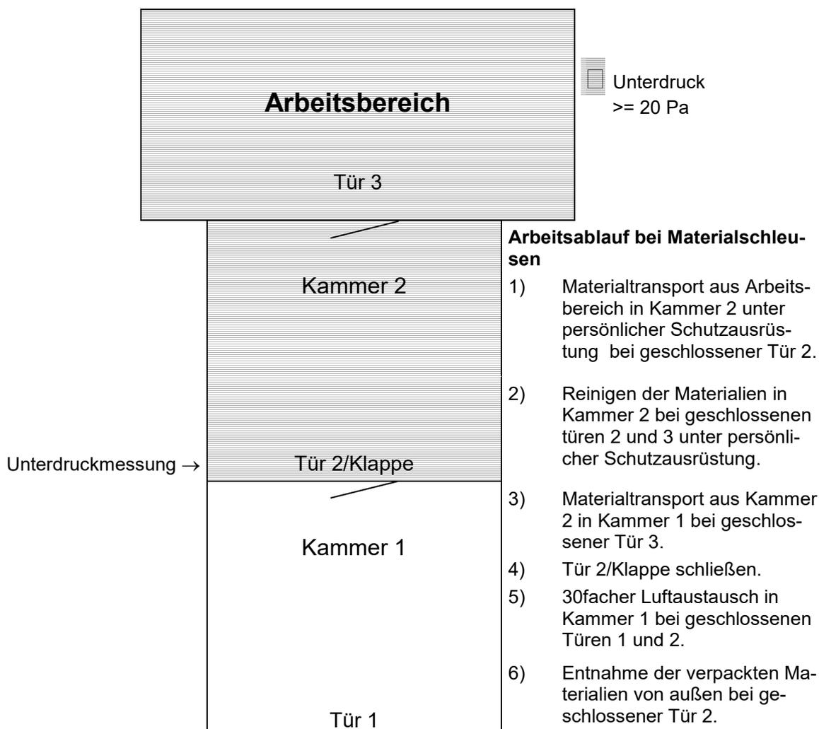
Abb. 2: Materialschleuse (Prinzipskizze)
